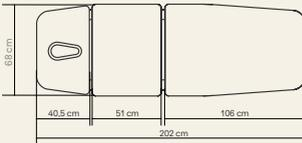
Table de traitement électrique à 3 plans qui permet plusieurs positions pour un confort optimal. Appui-tête réglable pour des ajustements d'angle positif et négatif pour les manipulations cervicales. Section centrale fixe. Pompe hydraulique de haute qualité activée par 2 leviers, un à chaque côté de la base, permettent de régler la hauteur de la table. Équipée d'un système de roues escamotables.
